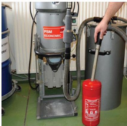
Porkiszívás zártrendszerű berendezéssel
